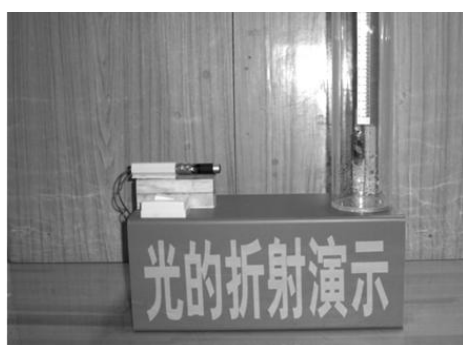
图 2 光在水柱中的全反射现象实验装置
